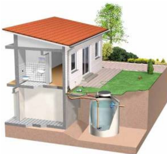
FIGURA 31 - Sistema de captação, filtragem e armazenamento de água da chuva
